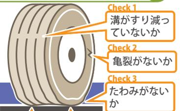
空気圧の低下によりタイヤがたわみ、接地面が両側に偏る
